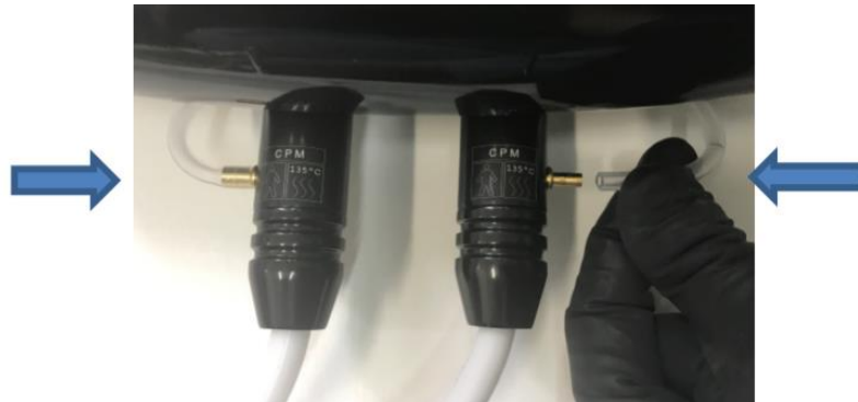
Figura 19: Conexão e desconexão da mangueira no cabo da peça de mão:
