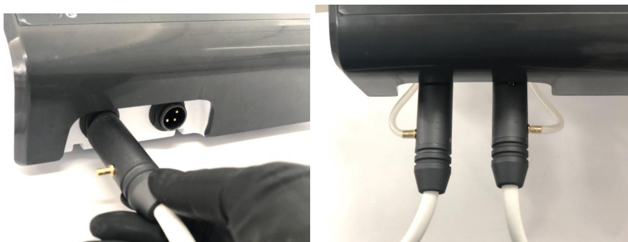
Figura 13. Conexão da peça de mão ao equipamento de ultrassom CLINICAL PLUS
