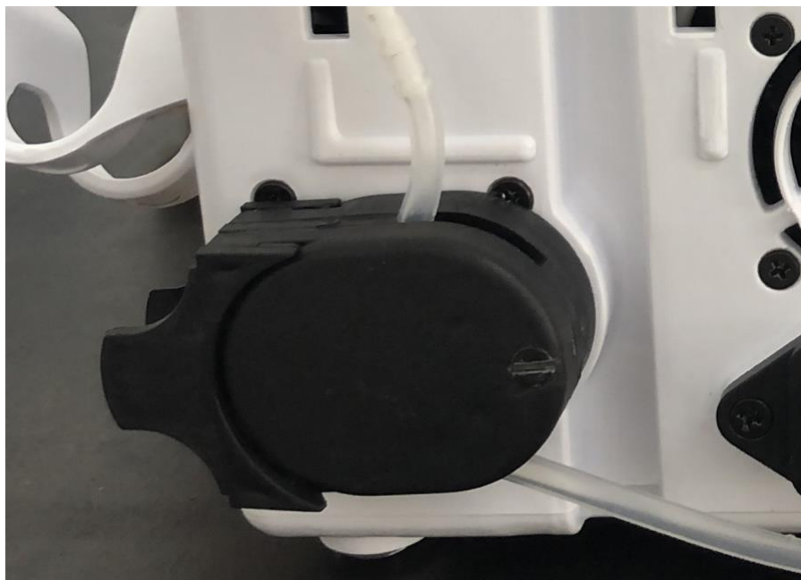
Figura 4: Circuito de refrigeração montado na unidade principal.
