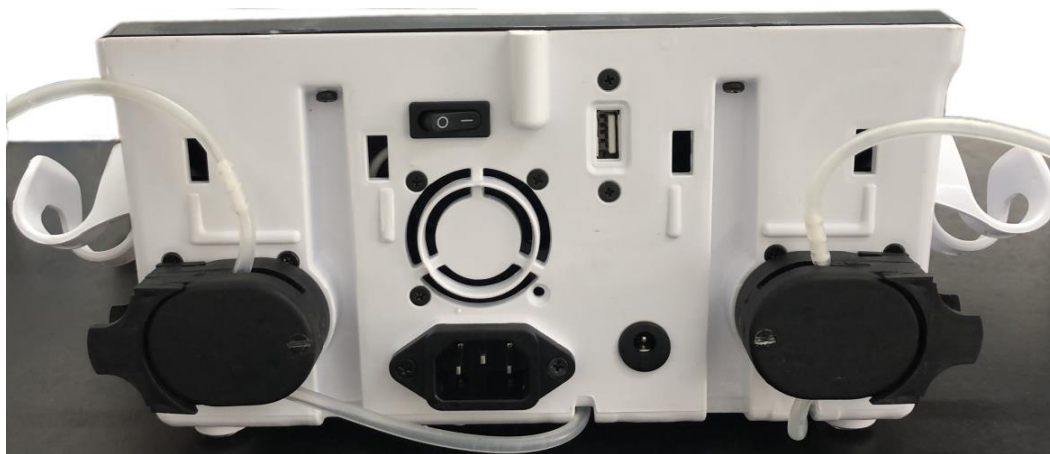
Figura 14. Traseira do equipamento de ultrassom CLINICAL PLUS , local de posicionamento da chave liga-desliga.
