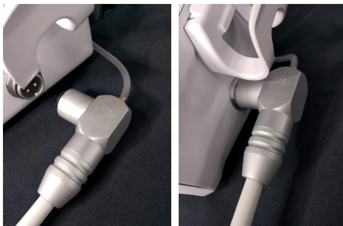
Figura 2: Detalhe do conector elétrico da peça de mão, mangueira e irrigação e seus métodos de conexão.
