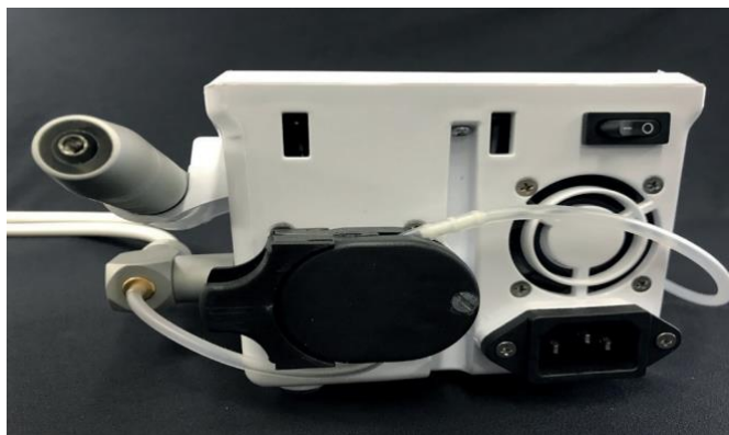
Figura 6: Bomba peristáltica montada no equipamento OPTYMUS.
