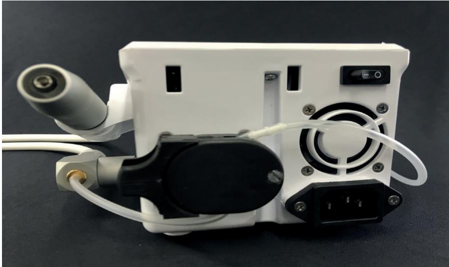
Figura 14. Traseira do equipamento de ultrassom OPTYMUS , local de posicionamento da chave liga-desliga.
