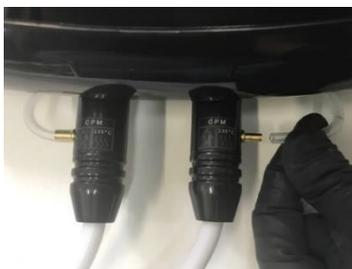
Segurar o conector do cabo da peça de mão e encaixar a extremidade da mangueira da bomba peristáltica, conforme mostrado na imagem. Com uma leve força colocar a mangueira até o final do conector. Para retirar: segure a mangueira e aplique uma leve força puxando a mangueira.
