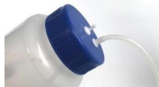
Imagem (A): O operador deve segurar a garrafa com a tampa fixa e colocar a mangueira da bomba peristáltica no conector localizado na tampa da garrafa. Com uma leve força colocar a mangueira até o final como mostrado na imagem (B). Para retirar: Segure a mangueira na mesma posição da imagem (A) e aplicando uma leve força puxe a mangueira.
