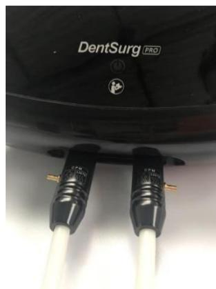
Segurar a região do conector do cabo da peça de mão (A). Encaixar a peça de mão no conector frontal do equipamento. Pressionar para uma completa fixação. Na imagem (B) o conector está totalmente fixo à unidade principal. Para desconectar, segure o conector e puxe na direção oposta ao conector.
