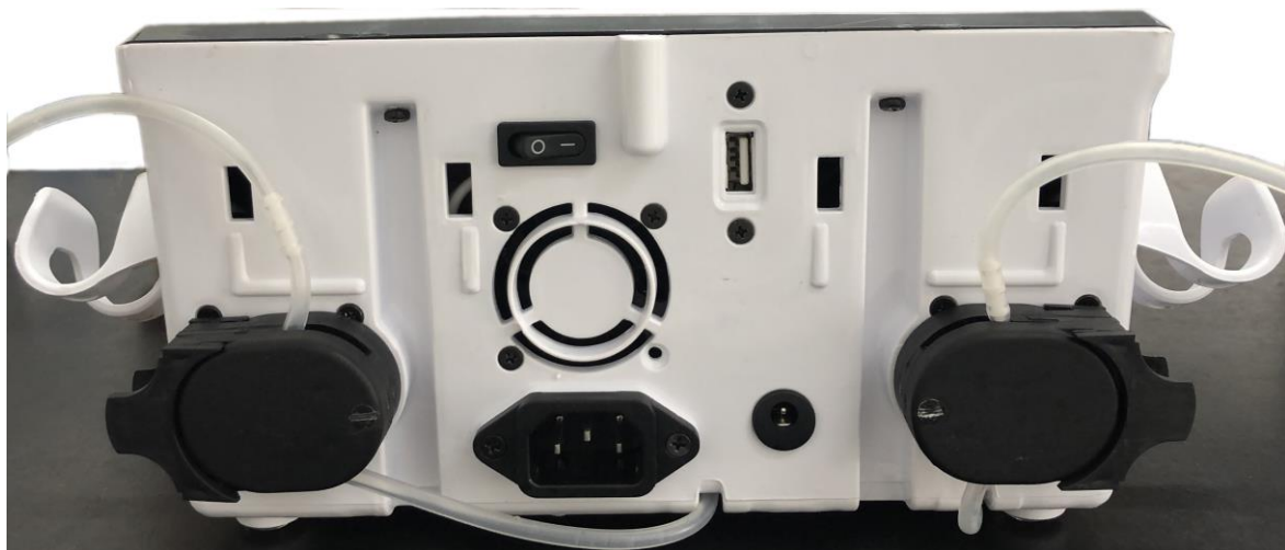
Figura 6: Bombas peristálticas montadas no equipamento CLINICAL PLUS.
