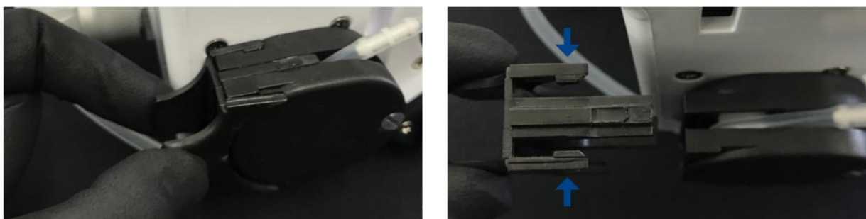
Figura 7: Pressione as aletas da gaveta (uma contra a outra) e puxe removendo-a e permitindo o acesso livre a mangueira de silicone.
