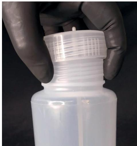
Segure a garrafa e retire a tampa, girando no sentido anti-horário (a). Retire a tampa (b) e coloque o líquido dentro da garrafa. Feche a garrafa girando a tampa no sentido horário. Nota: Antes de cada utilização faça a higienização da garrafa. Nunca deixe líquido dentro da garrafa caso o equipamento não esteja em utilização.
