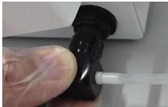
Imagem (a): Segurar a região do conector do cabo da peça de mão para apoio a conexão na unidade principal. Na imagem (b) o conector está totalmente fixo à unidade principal.
