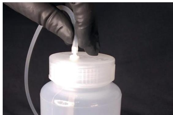
Imagem (a): O operador deve segurar a garrafa com a tampa fixa e colocar a mangueira da bomba peristáltica no conector localizado na tampa da garrafa. Com uma leve força colocar a mangueira até o final como mostrado na imagem (b).
