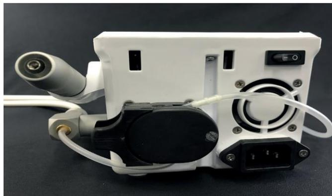
Figura 6: Bomba peristáltica montada no equipamento OPTYMUS.
