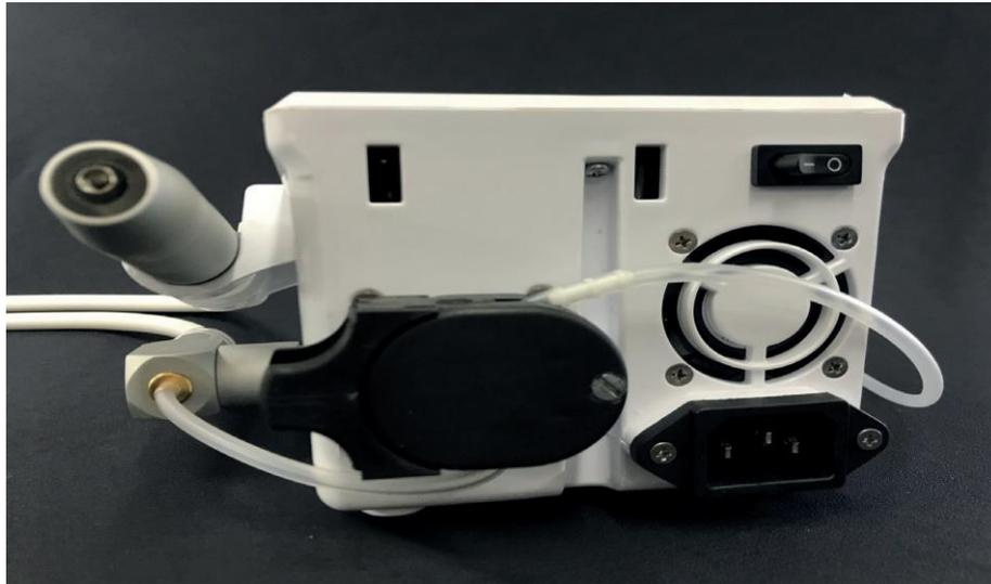
Figura 14. Traseira do equipamento de ultrassom **OPTYMUS**, local de posicionamento da chave liga-desliga.
